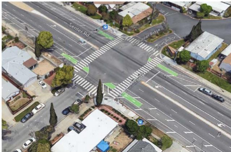
Làn đường xe đạp được bảo vệ như một phần của Dự Án An Toàn Vision Zero của Senter Road
